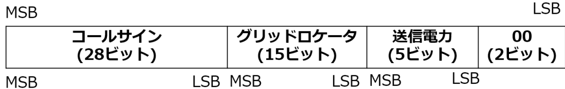
図 1 50 ビット長ペイロードに格納時のビット割り当て
