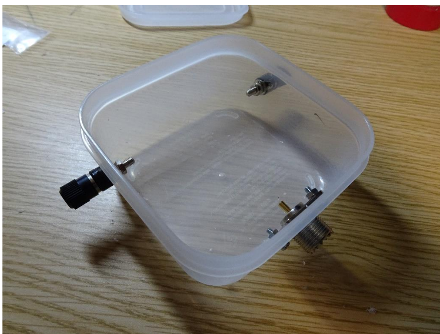
図 6 : M コネおよびターミナルの取り付け後の様子
