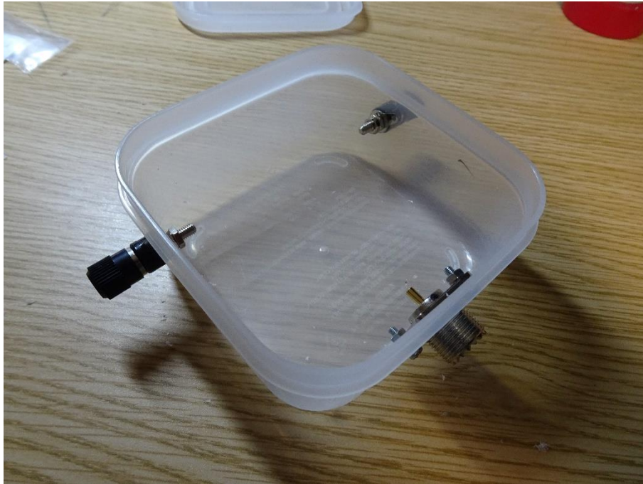
図 15 : M コネおよびターミナルの取り付け後の様子
